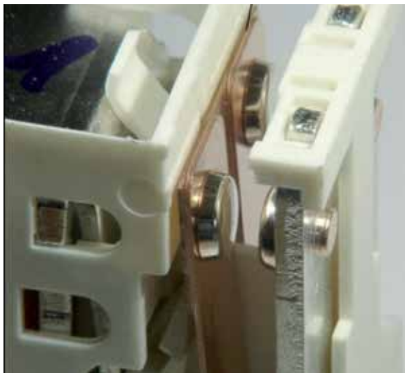
Abbildung 1: Thermische Brücke: Die wärmeleitende Kupferbrücke hinter den Kontaktzungen des Solarrelais sorgt für eine gleichmäßige Wärmeverteilung auch bei Überhitzung.
